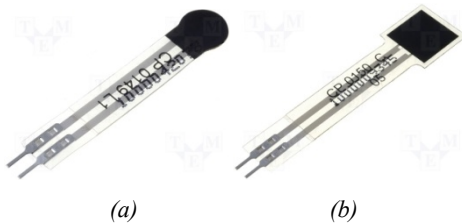
3. ábra. A használt CZN-CP6 (a) és CZN-CP9 (b) nyomásérzékelő bélyegek
