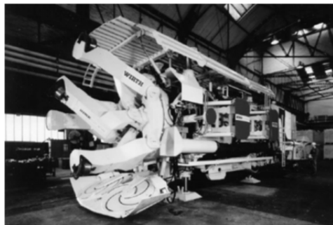
4. ábra. Többtárcsás karokkal ellátott alagút-furó gép. Kör alakú változtatható átmérőjű vágatok előhajtására alkalmas
