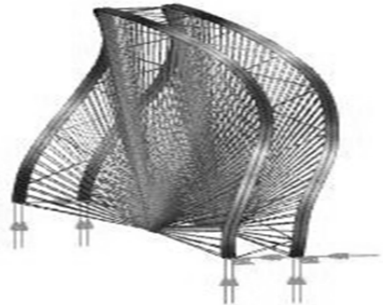
10. ábra. Kihajlás vizsgálata számítógépes modellen (másodfokú vizsgálat) [10]
