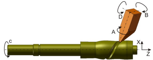
8. ábra. Az esztergáláshoz szükséges mozgások.
