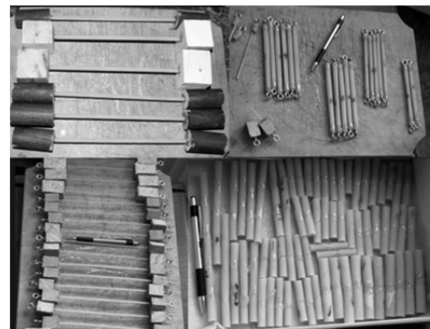
5. ábra. Próbatestek készítése az anyagjellemzők megállapításához [8]
