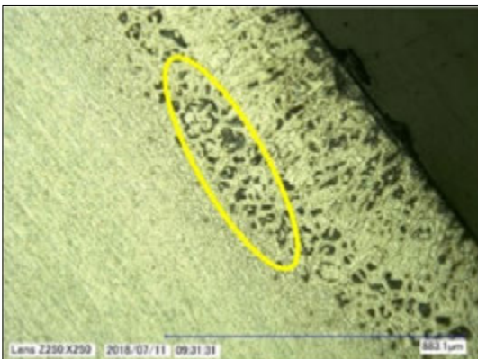
2. ábra. Lehetséges króm-nitrid-kiválások a ferrit-szemcsék belsejében, a hőhatásövezetben. Az ívenergia 0,25 kJ/mm, a védőgáz argon volt
