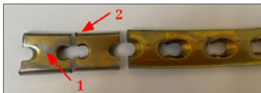
3. ábra. A csontrögzítő lemez disztális része a darabolást követően. A töretfelületet tartalmazó szelét 1-es, a metallográfiai és keménységmérési vizsgálatokhoz használt darab 2-es számmal jelölve
