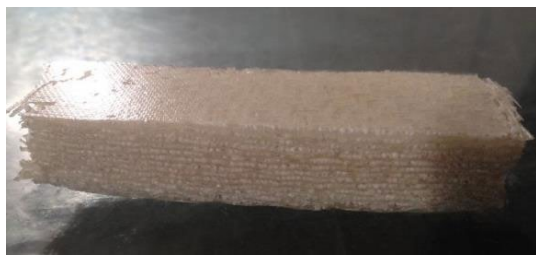
3. ábra. Kerámia gömbhéjakkal és üvegszövetrel erősítve
