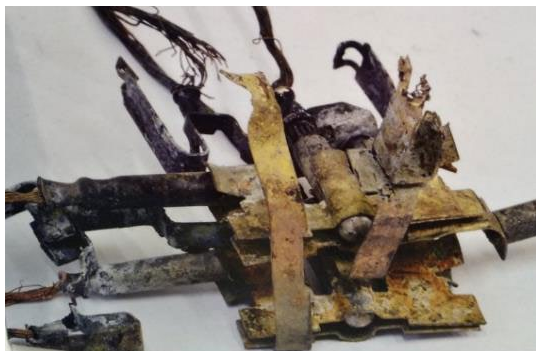
2. ábra. Kontaktkorrózió okozta károsodás villamoskötésnél
