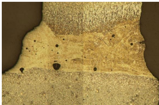
3. ábra. Lézerhegesztett varrat optikai mikroszkópos felvétele
