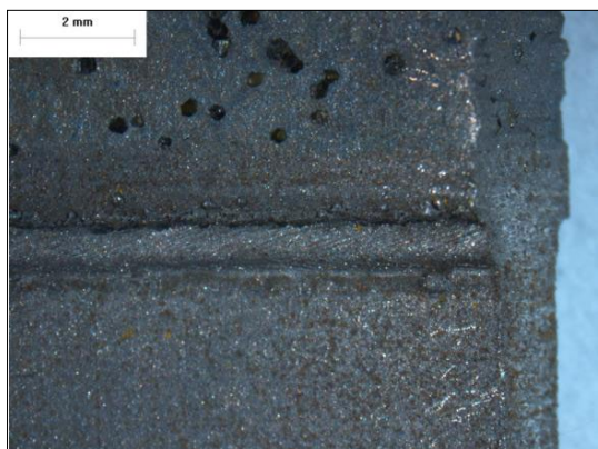
2. ábra. Lézerhegesztett varrat gyökoldali sztereomikroszkópos felvétele
