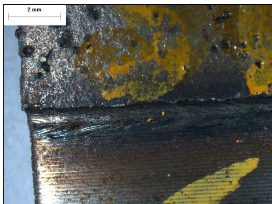
1. ábra. Lézerhegesztett varrat koronaoldali sztereomikroszkópos felvétele
