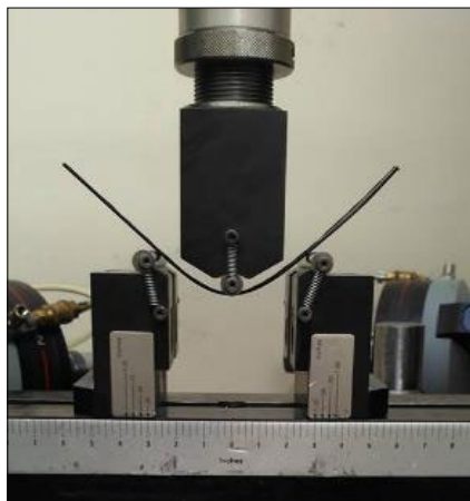
6. ábra. A próbatestet a hajlítóvizsgálat közben
