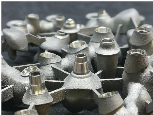
5. ábra. Az illeszkedőfelületük készre munkálásával rendelkező fogmű-vázszerkezetek
