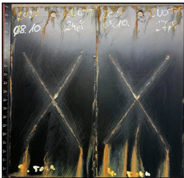
■ 3. ábra. KTL festett mintalemez, vas-foszfát + passziválás előkezeléssel, „X” kereszt-karccal bemetszve, 504 órás sóspárás közegben tartózkodás (korróziós teszt) után készült fényképe. (Forrás: saját fotó)
