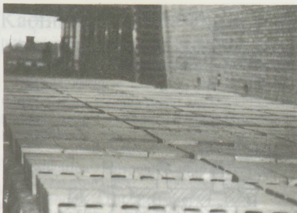
5. ábra Alagútkemence-kocsi huzatkövekkel
