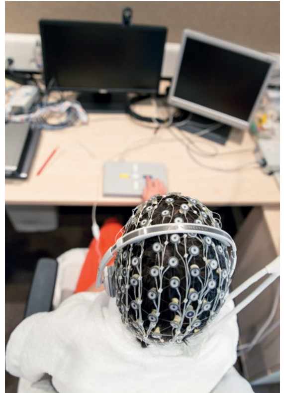
Az agyi elektromos válaszok elvezetésére rugalmas hálóban elhelyezett 128 elektróda szolgál
