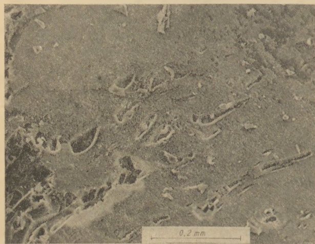
4. ábra. Üveges, alkattan kőzetalkotó perlitben (pásztázó elektronmikroszkópos kép, SZIKKTI)
