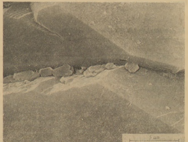
8. ábra. Kvarc-kristályok kötődése hárshegyi homokkőben (pásztázó elektronmikroszkópos kép, SZIKKTI)
