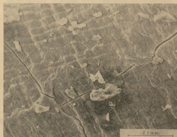
6. ábra. Hajszálrepedéses pórus alkattan kőzetalkotók között (pásztázó elektronmikroszkópos kép, SZIKKTI)
