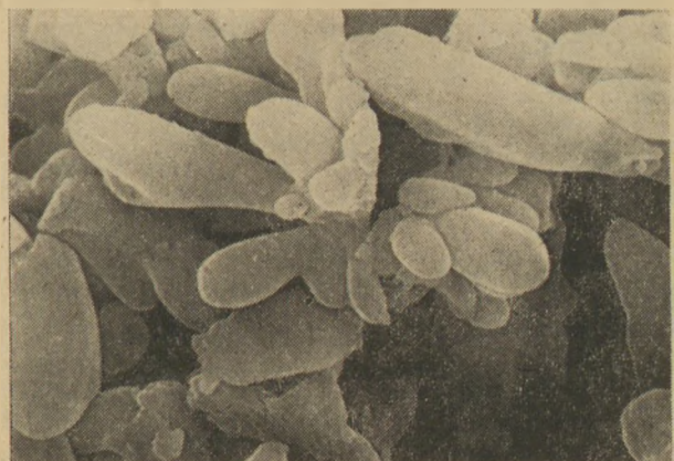
19. ábra. 700^\circ\text{C} -on 90 percig hőkezelt üveg felszíne; 10\,000\times
