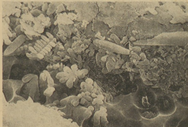
18. ábra. 700^\circ\text{C} -on 90 percig hőkezelt üveg felülete; 3\,000\times
