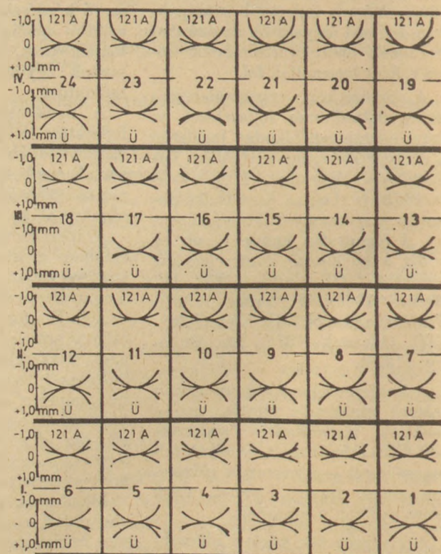
2. ábra. A 24 csatornás tolólapos kemencében égetett csempek deformáció iránya
