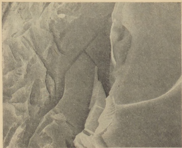
6. ábra. Orosházi síküveg történek „hideg”-oldali széle; 1100 ×
