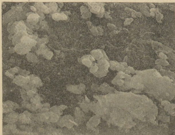
6. ábra. 520 °C-on 4 órán át hőkezelt nátrium-szilikát üveg felületi kristálykiválásai: maratatlan: 11 000 ×
