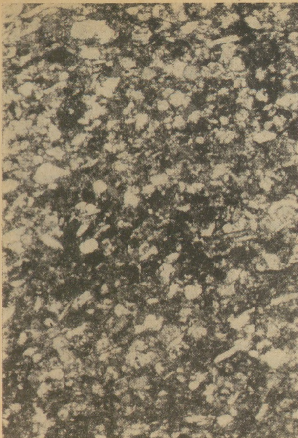
4. ábra. Kvarcot-csillámféléket tartalmazó karbonátos kötőanyagú dolomitmárga (Mecsek hg., Patacs) (Leitz-Pol. N+, Nf = 300×)
