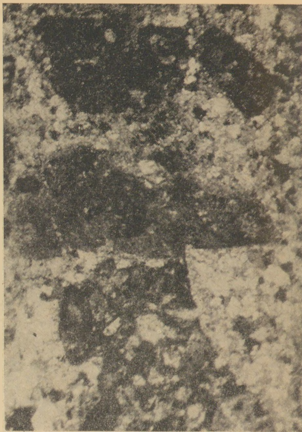
7. ábra. Átkristályosodóban levő pelletes biomikrit, az alpmátrix fokozatos megemésztődését mutatja a szemcsés dolopát megjelenése mellett (Balinka). (Leitz-Ortolux-Pol. N+, Nf = 200x).
