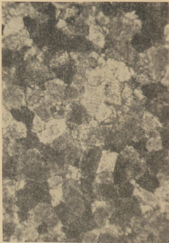
8. ábra. Szemcseméretnövekedéssel tökéletesen átkristályodott dolopátit, jellegzetes dolomitfoltossággal (Guttamási). (Leitz-Ortolux-Pol. N+, Nf = 200x)
