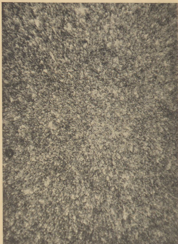
6. ábra. Dolomitkristtá átalakult, eredetileg meszes biomikrit (Balinka). (Leitz-Ortolux-Pol. N+, Nf = 200x)
