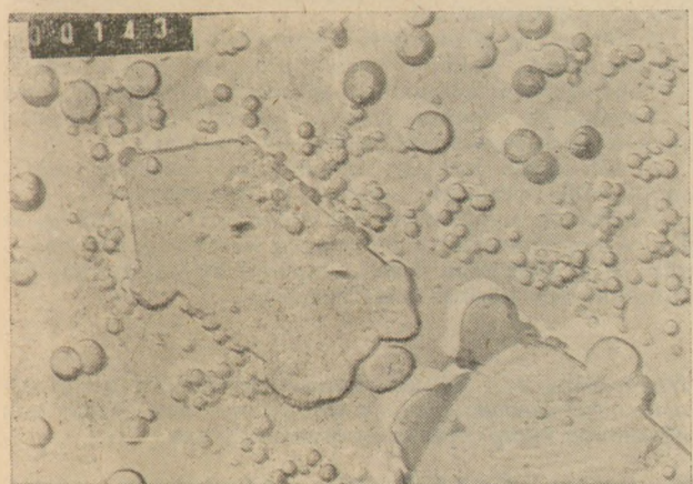
5. ábra. Az üvegek elektron-mikroszkópos felvételei: a) 750 °C/2 óra; b) 900 °C/1,5 óra; c) 950 °C/1,0 óra; d) 1100 °C/1,0 óra
