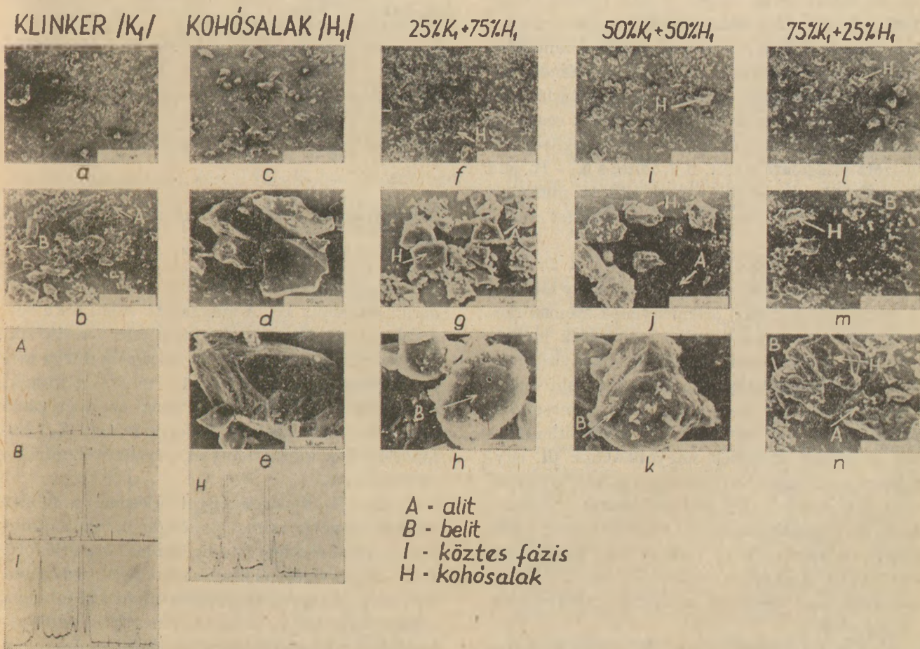
2. ábra. Az őrlmények tanulmányozása scanning elektron-mikroszkóp és mikroszonda segítségével
