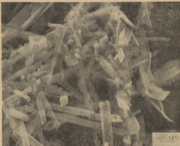
5. ábra. Csőalakú kristályok a B-adag töretéről 11 000-szeres nagyítással készült felvételen
