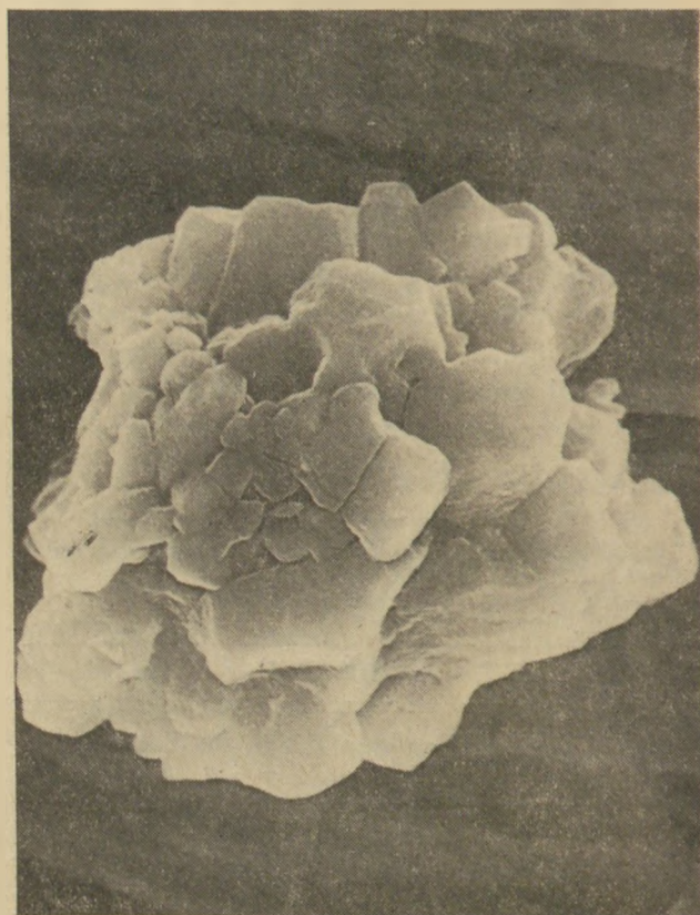
10, 11, 12, 13. ábrák Hexameta-foszfát oldatban különböző ideig szuszpendált szemcsék SEM felvétele nagyítás: 6000×
