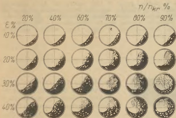
10. ábra. Amerikai vizsgálatok átlátszó homlokfalú laboratóriumi golyós malommal [6]
