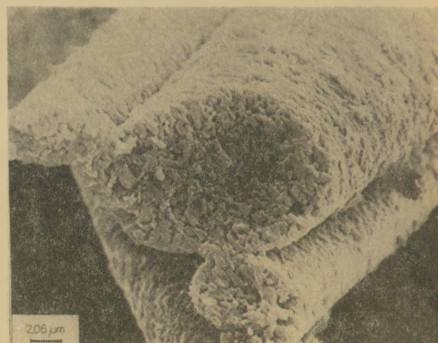
8b. felvétel: Az 1173 K-en 3h-t hőkezelt „TR/125” bazaltgyapot-szál 3% HF + 10% H 2 SO 4 oldattal végzett 5 min kezelés után
