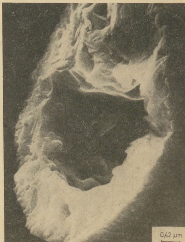
3a. felvétel: Bazaltgyapot-szál 1173 K-en 3h hőkezelés után
