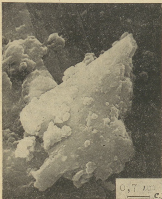
1. ábra. A bayerit morfológiai változásai az őrlés hatására a) az őrlés előtt, b–d) az őrlés után
