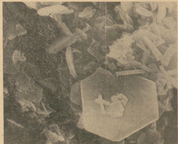
10. ábra. A 750^\circ C -on kezelt AlF_3 szerkezetéről készített Scanning-elektronmikroszkópi felvétel 11000-szeres nagyításban
