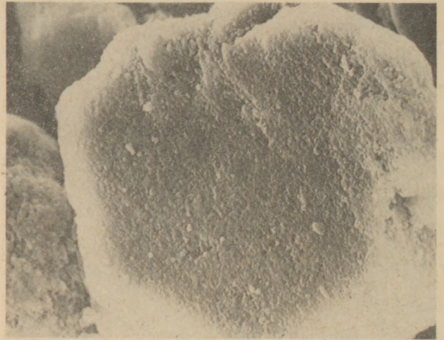
3. ábra. Alumíniumfluorid szemcse konglomerátum elektronmikroszkópi képe 3300-szoros nagyításban
