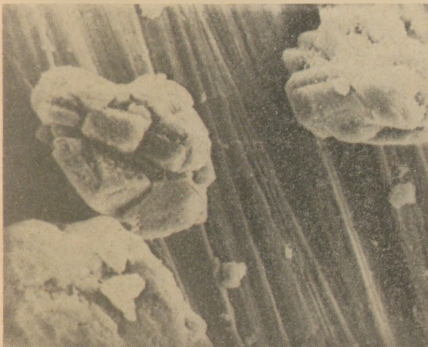
2. ábra. Alumíniumfluorid szemcsék elektronmikroszkópi képe 1100-szoros nagyítás mellett (11 \times 13,5 cm képméret)
