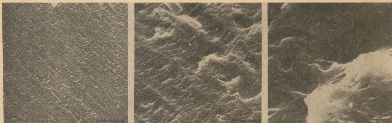
9. ábra. Mikrofelvétel homokkővel köszörült üveg felületi egyenlőtlenségeiről, kagylószerű kitüredézzel (Mairlot után) 130×960×, 6600×-es nagyítás
