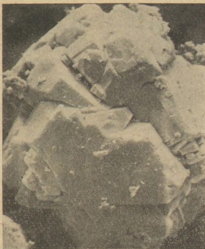
3. ábra. Lassú és gyors felfűtéssel 1600 °C hőmérsékleten kalcinált alumínium-oxidok szemcséiről készült scanning elektronmikroszkópos felvételek. (Vasipari Kutató Intézet, Típus: JSM-S1)
