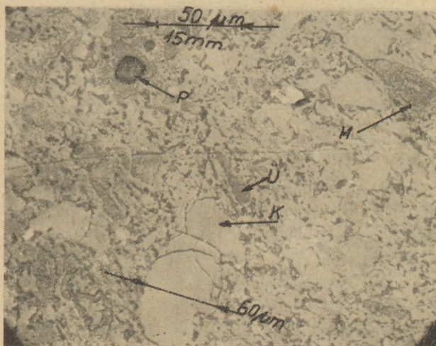
6. ábra. Az 1100 °C hőmérsékleten hőkezelt minta fénymikroszkópos felvétele
