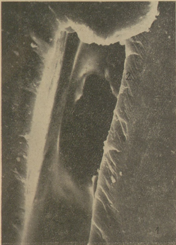
17. ábra. Szilícium-karbid kőszőrűszemcse (1) és kerámiai kötőanyag (2) fázishatárának scanning elektronmikroszkópos felvétele (9000 ×)
