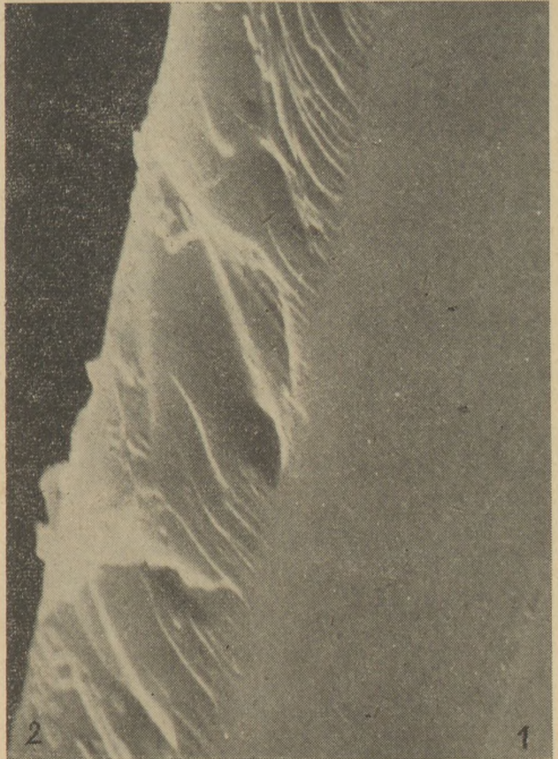
19. ábra. Szilícium-karbid kőszőrűszemcse (1) és kerámiai kötőanyag (2) fázishatárának scanning elektronmikroszkópos felvétele (6000 ×)
