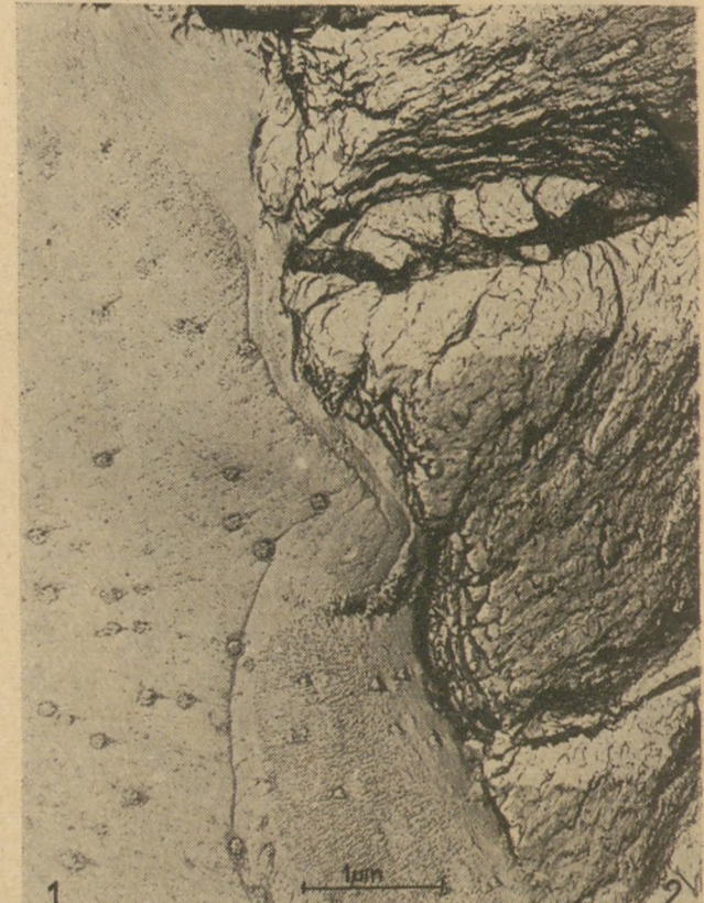
24. ábra. Szilícium-karbid köszörűszemcse (1) és kerámiai kötőanyag (2) fázishatárának elektronmikroszkópos felvétele (26000×)
