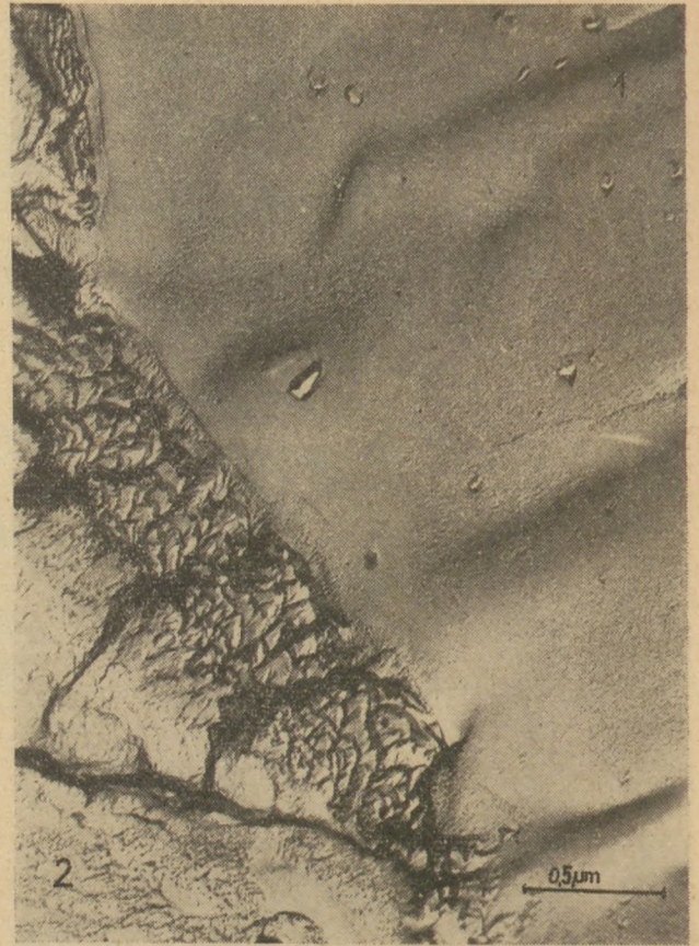
23. ábra. Szilícium-karbid köszörűszemcse (1) és kerámiai kötőanyag (2) fázishatárának elektronmikroszkópos felvétele (54000×)
