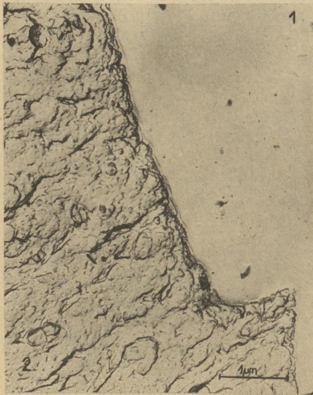
22. ábra. Szilícium-karbid köszörűszemcse (1) és kerámiai kötőanyag (2) fázishatárának elektronmikroszkópos felvétele (26000×)
