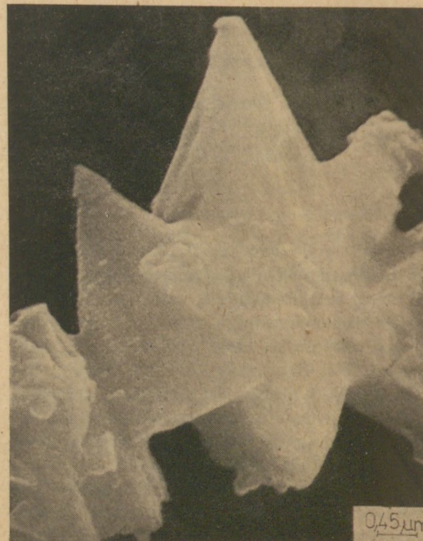
2. ábra. a) A bayerit SEM felvétele ( 22\ 000\times ) b) A 350^\circ\text{C} -on izzított bayerit SEM felvétele ( 22\ 000\times )
