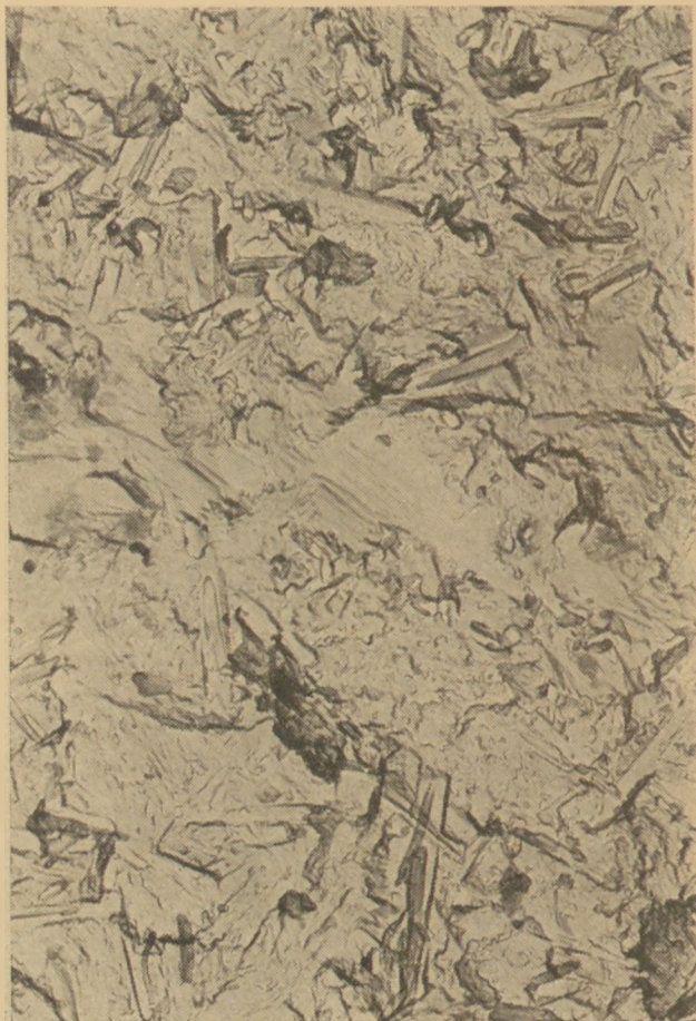
13. ábra. Optimális (2,46%) és túladagolt hidratált cement elektronmikroszkópi képe 3 éves korban. (Nagyítás: 18 000×)
