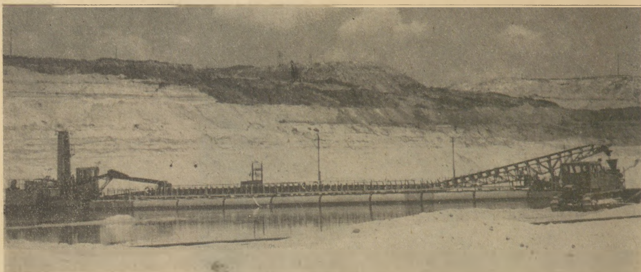
2. Harkov közeli homokbánya. Szovjetunió. HP-IX-30 típusú hidrop úszókotró. UD-1600/47 típusú Dekolt víztelenítő szalag
