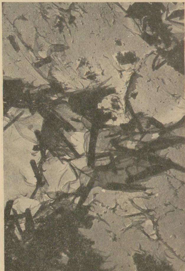
9. ábra. Túladaagolt (4,60%) SO 3 tartalmú hidratált cement elektronmikroszkópi képe 28 napos korban. (Nagyítás: 18 000 ×)
