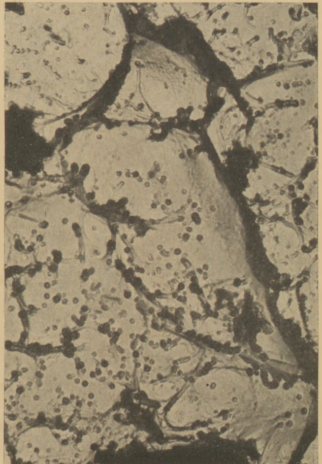
5. ábra. Túladagolt (4,60%) SO_3 tartalmú hidratált cement elektronmikroszkópi képe 3 napos korban. (Nagyítás: 27 000 \times )
