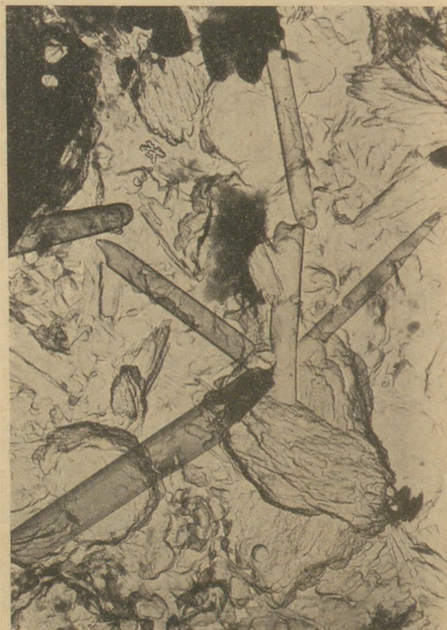
14. ábra. Túladagolt (4,60%) \text{SO}_3 tartalmú hidratált cement elektronmikroszkópi képe 3 éves korban. (Nagyítás: 24 000×)
