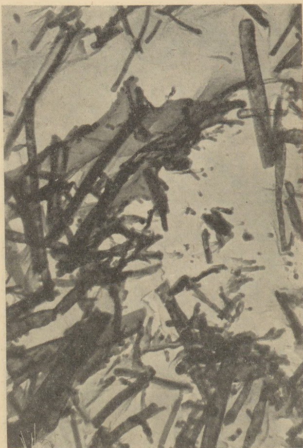
7. ábra. Túladaagolt (4,60%) SO 3 tartalmú hidratált cement elektronmikroszkópi képe 7 napos korban. (Nagyítás: 12 000 ×)
