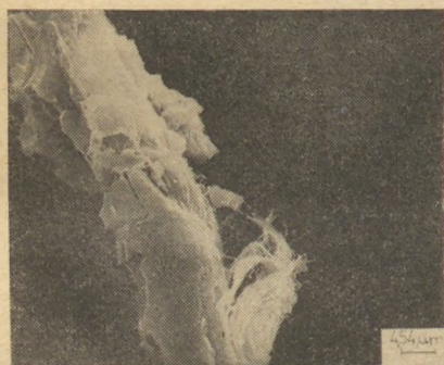
7–10. felvétel: HCl: víz = 1:3 3 perces kezelés hatására a bazaltszálak differenciált oldódását szemlélteti
