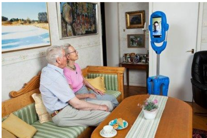
A Zsiráf elnevezésű telepresence robot, melyet kórházaknak és házi idősgondozóknak ajánlanak elsősorban
