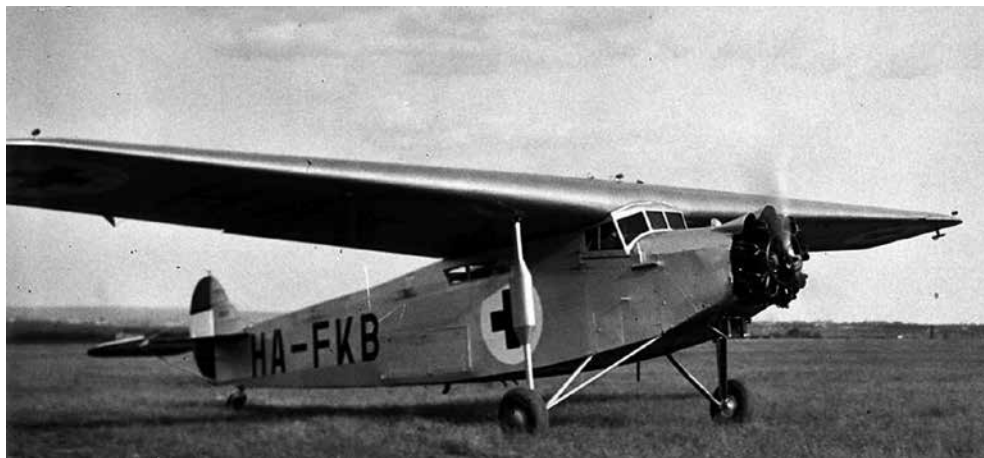
4. ábra. Egy jóminőségű fotó a HA-FKB (LÜH sz. 40.02) összekötő és mentőgépről. A vöröskeresztes jel mögött a törzsön a vízszintes téglalap alakú, a törzs síkjából kiemelkedő felület a betegszállító rekesz fedele.
