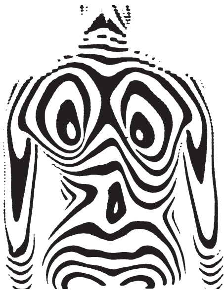
9. ábra. A Moiré Fringe Segmentation Tool prototípusában végrehajtott küszöbölés (thresholding) eredménye nagyítva
