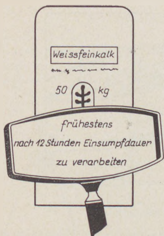
1. ábra. A DIN 1060 szerinti szabványos zsákfelirat, a felna gyított szükséges pihentelési előírással.
