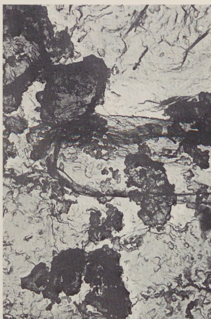
4. ábra. Rüdersdorfi cementek elektronmikroszkópi felvételei, 3 éves normál szilárdulás után. a) pernye nélkül, b) 40% vockerodei pernyével.
