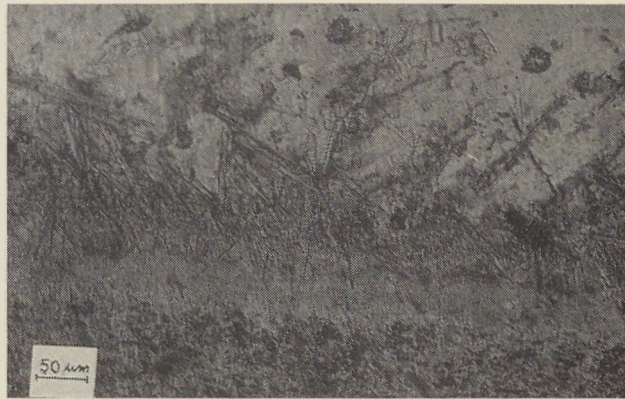
3. ábra. Másodlagos mullit kristályok a negatív elektród közelében kifejlődött üveges fázisban. A kristálymentes zóna is jól megfigyelhető
