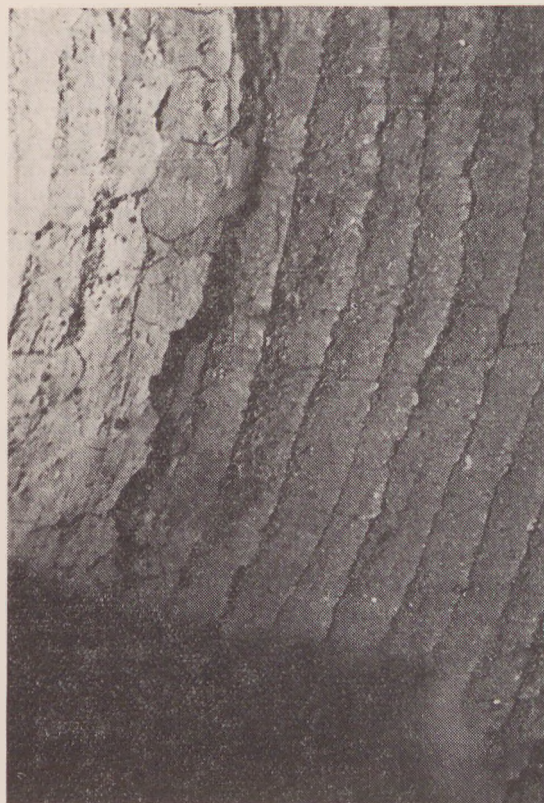
3. ábra. Ladelit „B” döngölőanyag állapota hiányos megmunkálás és feljűtés következményeként
