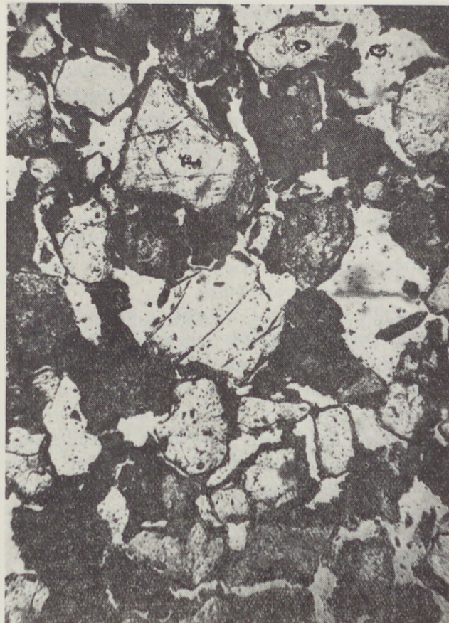
6. ábra. „B” réteg likacsos szövete (Kvarc Q, plagioklász P, kötőanyag Ó, likacsok 1/N = 100)
