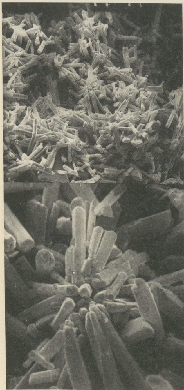
6. ábra. Hidratált anhidrit scanning-elektronmikroszkópi felvétele. (Nagyítás 1000 : 1 és 3000 : 1)
