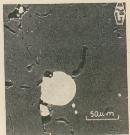
6. ábra. 0,2% széntartalmú, olvadékból öntött korundkő anyagszövetképe. Pórusok és fémes zárványok
