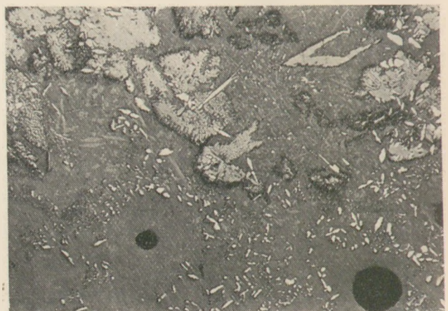
7. ábra. Oldódási öblök szekunder-mullit képződményekkel
