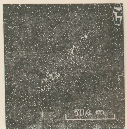
15. ábra. A szulfid-tartalom helyi eloszlásának képe a 10. ábra területén. Olvadékból öntött mullitkő anyagszövetképe
