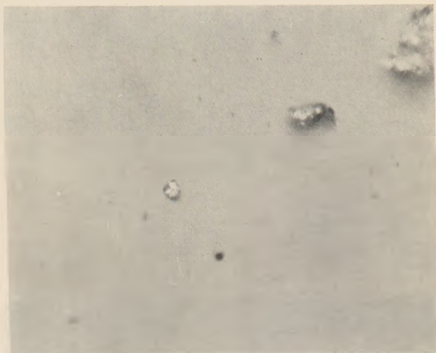
5. ábra. Síküveg friss törésfelülete. 500 × (7)
