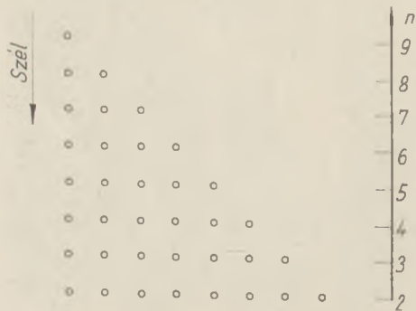
8. ábra. A = elektródák kölcsönhatásának vizsgálata egy mért elektródával, de a rajz szerint elhelyezett különböző számú működő szóróelektródák esetére
