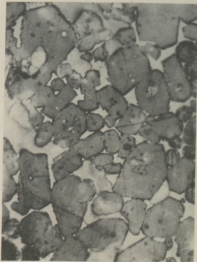
8. ábra. Alitos klinker csiszolatának mikrofelvétele
