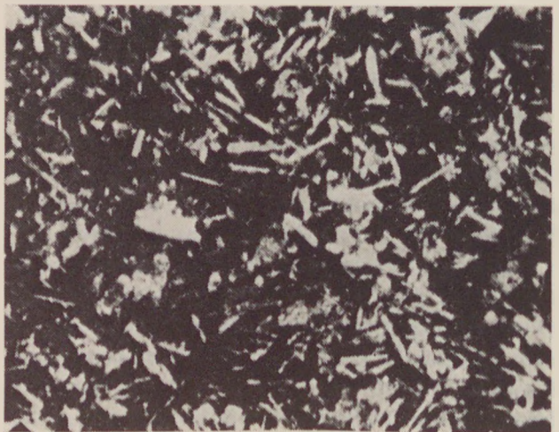
6. ábra. Bazalt csiszolatának mikrofelvétele
