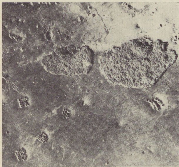
4. ábra. Tetőcserep helyenként levált, tűszúrásos mázfelülete (Ulm)
