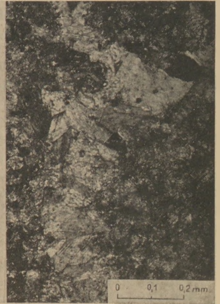
19. ábra. Rekrisztallizációval metamorf hatásra megnövekedett karbonátszemcsék, csúszási nyomokkal (10. sz. fúrás 83,5 m)
