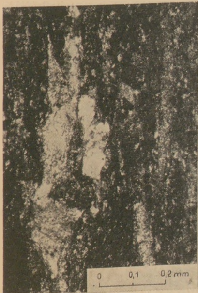
17. ábra. Megnövekedett karbonát-tartalmú lencsék az irányított szövetű réteglapok közé ékelődve (10. sz. fúrás 49,0 m)
