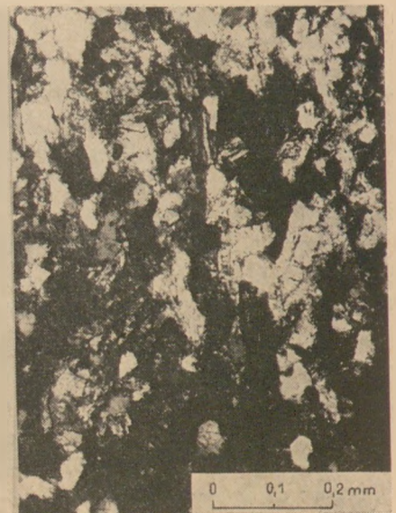
13. ábra. Agyagos, csillámos mészpala, metamorf hatásra képződött jelentős szemcsedurvulással (9. sz. fúrás 60,2 m)
