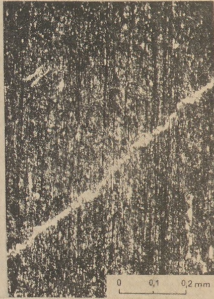
9. ábra. Préselésből eredő finom lemezes textúra az agyagpalában, a réteglemezek mentén diffúz limonitós, kvarcos átitatással (6. sz. fúrás 33,0 m)
