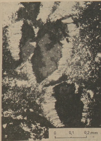
15. ábra. Limonitosodott üregekben képződött, sugaras kalcedon kiválások (10. sz. fúrás 3,0 m)
