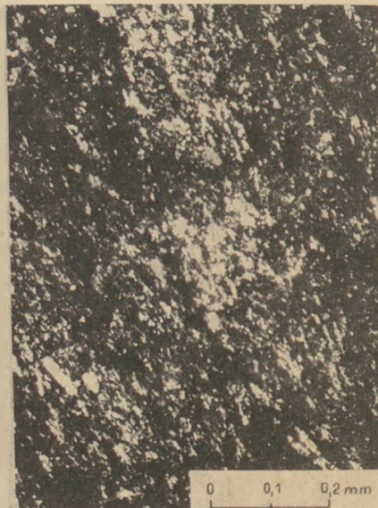
12. ábra. Irányítatlan szövettel rendelkező bitumenes agyagpala, porfírosan hintett plagioklással és kvarccal (9. sz. fúrás 20,7 m)
