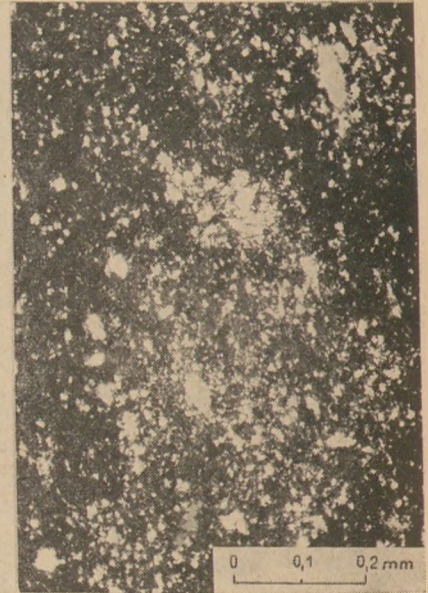
10. ábra. Diffúz eloszlásban mutakozó szemporfíros kvarc, földpát, csillámcsék, irányítatlan szövettel (6. sz. fúrás 34,1 m)
