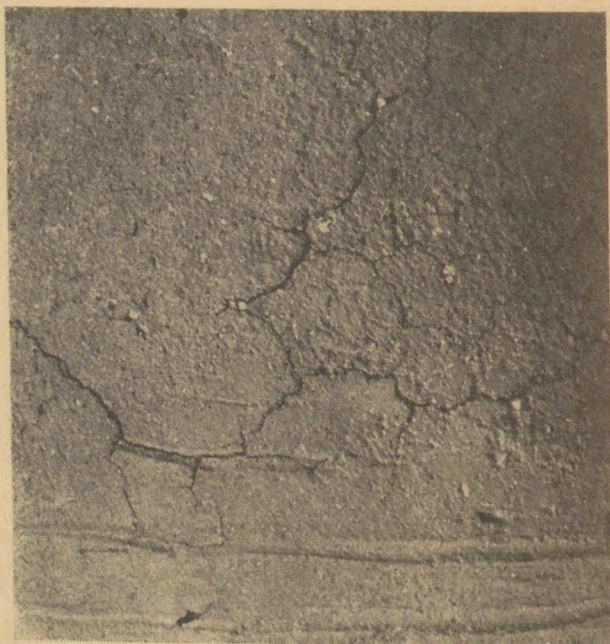
1. ábra. Cserépanyag felületén vízfelvétel hatására keletkező repedések (X—XI. sz. Oroszvár) — Susits L. felv. —
