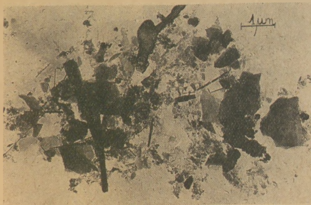
2. ábra. Kisgyőri agyag oldásos kezelés után. (18 000-szeres nagyítás)
