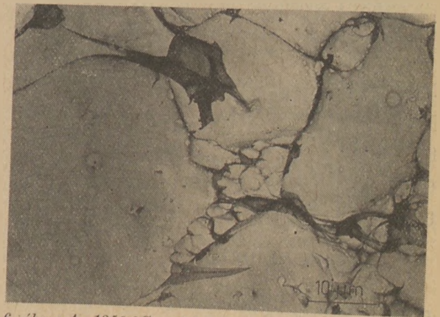
6. ábra. Az 1350 °C-on 60 perc hőntartással égetett félvezető BaTiO_3 kerámia elektronmikroszkópi képe
