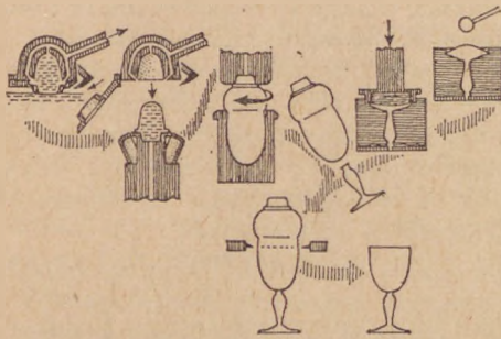
4. ábra. Vékonyfalú kehelyüvegek csészéjének automata (pl. IFA) vagy félautomata (pl. Kiko) fúvógéppel; s szárának és talpának egyidejűleg préseléssel való gyártásának vázlatja
