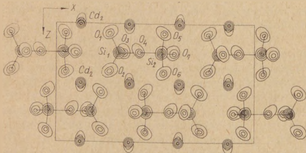
9. ábra. A \text{Gd}_2\text{Si}_2\text{O}_7 szerkezete
