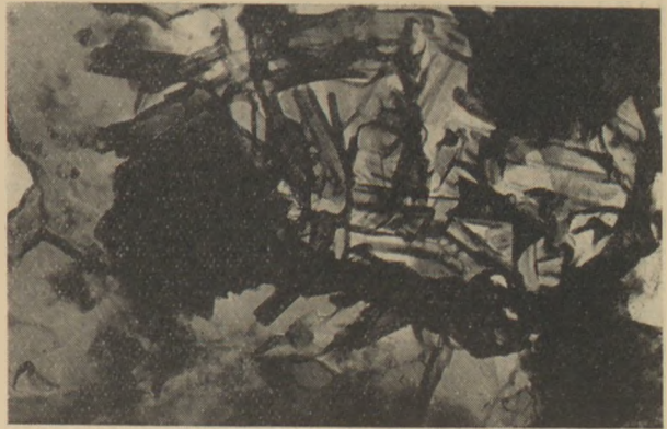
9. ábra. 1 mól gipszsel 20°C-on hidratált C_3A
