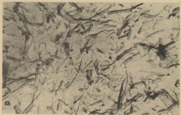
10. ábra. 1 mól gipszsel 80°C-on hidratált C_3A
