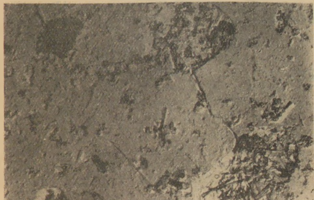
2. ábra. Ettringit kristályok 7 napos portlandcementben
