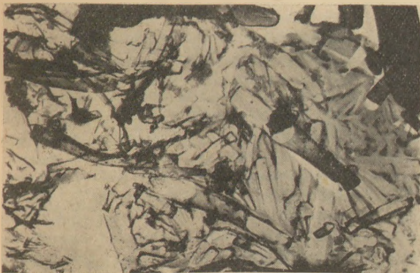
8. ábra. 3 mól gipszsel 80°C-on hidratált C_3A
