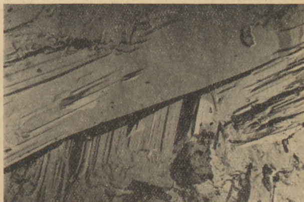
3. ábra. Portlandit kristályok 28 napos portlandcementben
