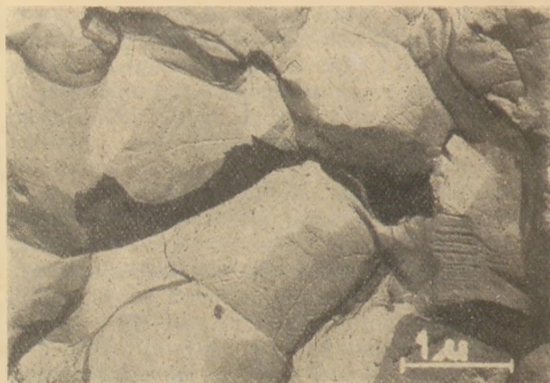
6. ábra. x=0,60 összetételű, 1280^{\circ}\text{C} -on 1 órán át égetett Ni—Mn spinell tárcsa törési felületének elektronmikroszkópos képe
