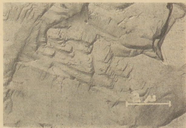
7. ábra. x=0,70 összetételű, 1280^{\circ}\text{C} -on 1 órán át égetett Ni—Mn spinell tárcsa törési felületének elektronmikroszkópos képe
