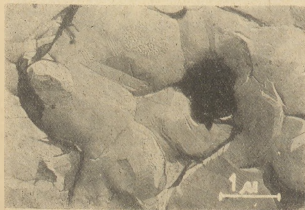
5. ábra. x=0,44 összetételű, 1280^{\circ}\text{C} -on 1 órán át égetett Ni—Mn spinell tárcsa törési felületének elektronmikroszkópos képe
