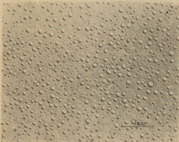
3. ábra. 2 órán keresztül 735^\circ\text{C} -on hőkezelt 4 \text{Li}_2\text{O} \cdot 36 \text{B}_2\text{O}_3 \cdot 60 \text{SiO}_2 összetételű üveg szerkezete
