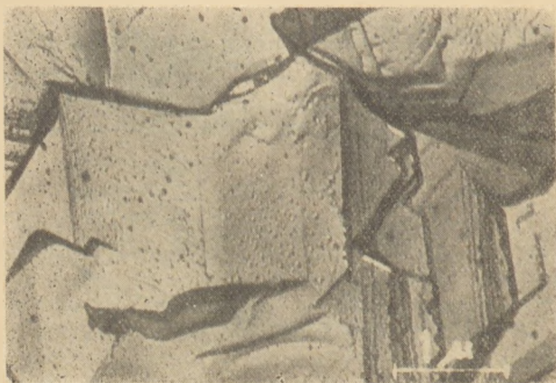
3. ábra. x=0 összetételű, 1280^{\circ}\text{C} -on 1 órán át égetett Ni—Mn spinell tárcsa törési felületének elektronmikroszkópos képe
