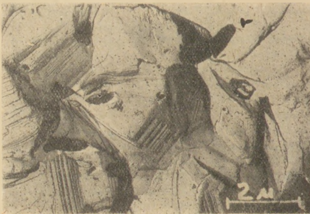
8. ábra. x=0,80 összetételű, 1280^{\circ}\text{C} -on 1 órán át égetett Ni—Mn spinell tárcsa törési felületének elektronmikroszkópos képe
