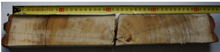
3. ábra A Tiszadob 20E ültetvényről származó nagy átmérőjű vizsgálati faanyag égvűrűszerkezete
