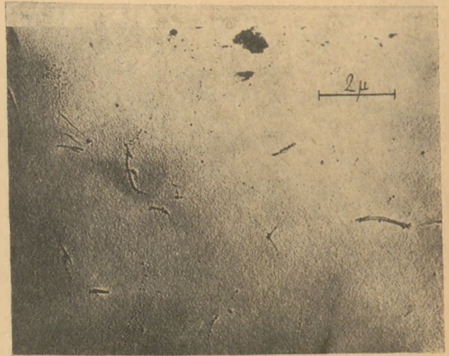
8. ábra. Mullitbázisú kiégetett, használatlan tégely szerkezetének elektronmikroszkópi képe (C-replika, gőzölt.) Egyenletes szerkezet N=6000
