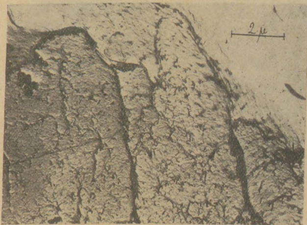
11. ábra. Mullitbázisú kiégetett, használatlan tégelyanyag szerkezetének elektronmikroszkópi képe. (C-replika, gőzölt.) Nagyméretű mullitkristályok. N=9000
