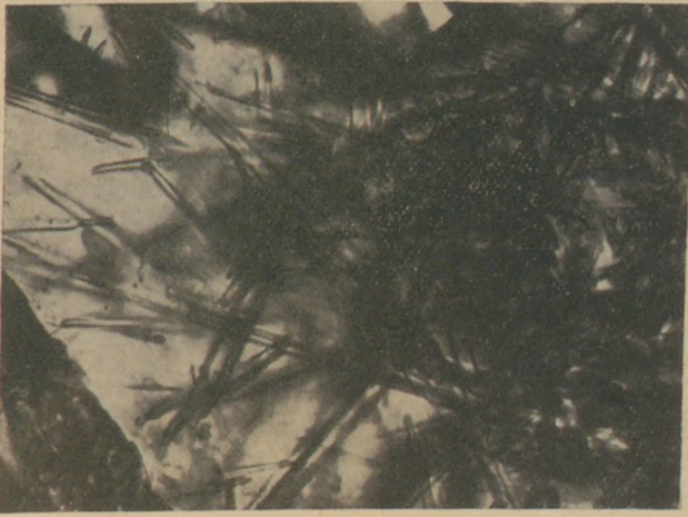
17. ábra. Mullitbázisú üvegolvasztó tégely kontaktusrétegében fénymikroszkópban, áteső fényben látható tégelyszerkezetből kiszabadult mullitűk. N = 500
