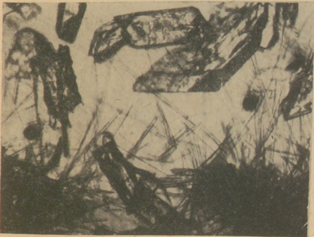
19. ábra. A mullitbázisú üvegolvasztó tégely kontaktusrétegében keletkezett korundkristályok. N = 315
