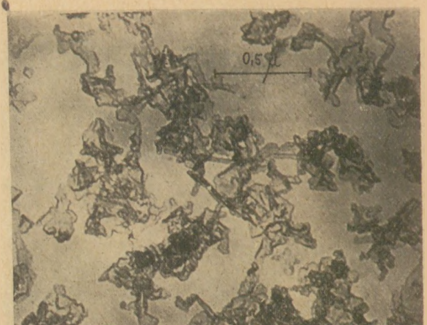
26. ábra. Mullitdús üvegolvasztó tégely oldódásában levő szövetszerkezetének elektronmikroszkópi felvétele. N = 31\ 000
