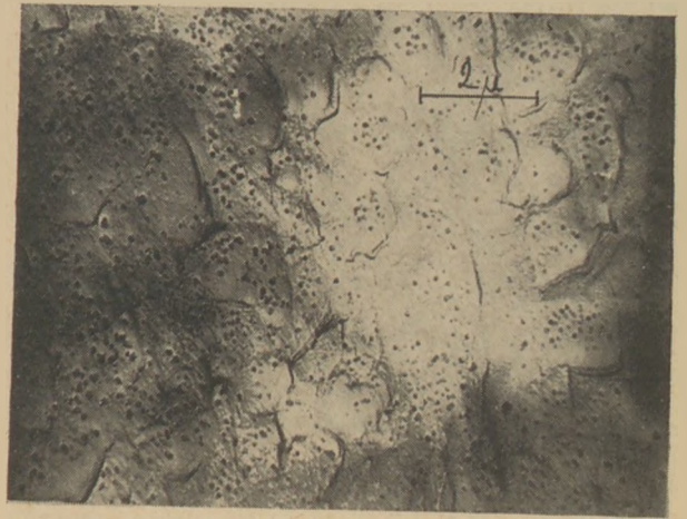
21. ábra. A használt mullitdús tégely kontaktusrétegéhez közel eső szövetelem elektronmikroszkópi képe, részben perforálódó mullitkristályok. N = 6000 . (C-replika.)
