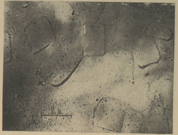
20. ábra. A használt mullitdús tégely kontaktusrétegéhez közel eső szövetelem elektronmikroszkópi képe. N = 6000 . (C-replika, gőzölt.)
