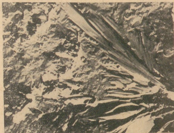
6. ábra. A váci 600-as portlandcementpép törési felületének különböző típusáról készített elektronmikroszkópos felvételek (mikroszkóp nagyítása 3000×)
