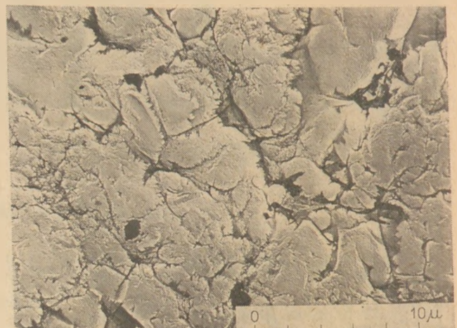
2. kép. Az M-6. sz. fúrás 50,5 m-ből származó, hidrotermálisan bontott agyagos mészkő elektronmikroszkópi képe
