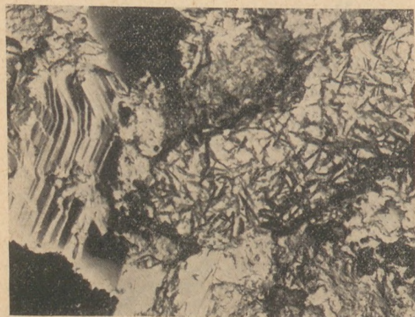
6. ábra. A váci 600-as portlandcementpép törési felületének különböző típusáról készített elektronmikroszkópos felvételek (mikroszkóp nagyítása 3000×)
