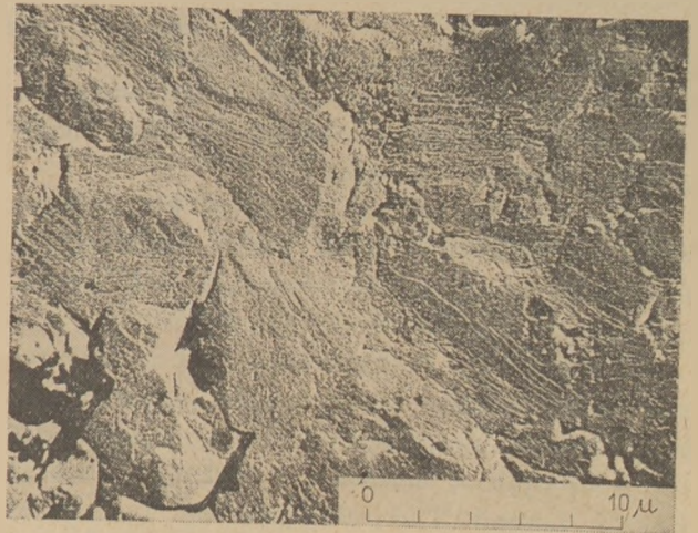
7. kép. Az M-2. sz. fúrás 55,3 m-ből származó meszes dolomit elektronmikroszkópi képe
