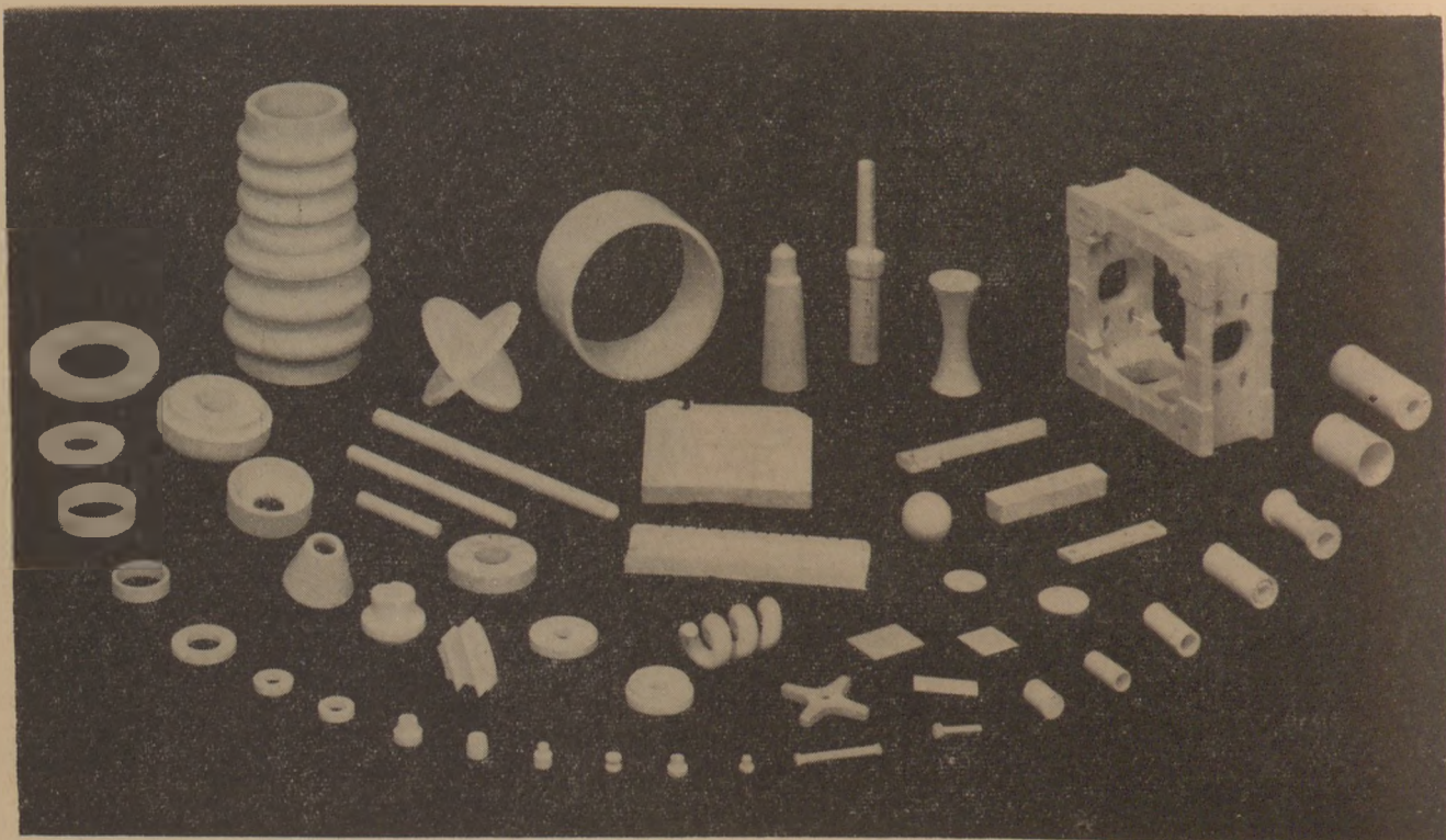
4. ábra. HIKI-ben előállított „TIMALOX” korund. A jobboldali látható „keret” alakú idom külső méretei: 90 \times 80 \times 40 mm, súlya 330 g
